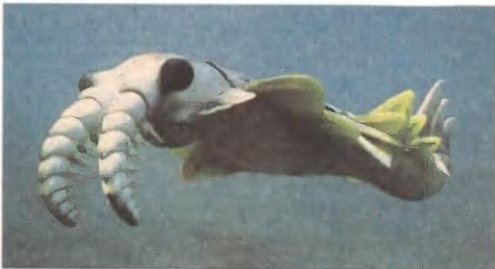
хронно спереди назад, модель плавно, без качания плыла вперед, а если волну пускали в обратном направлении, — теряла скорость, клевала носом, а затем начинала медленно двигаться задним ходом. Гоня волну на правой и левой половине тела в противофазе, можно было управлять движением модели так, что она поворачивалась на месте.
